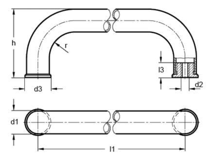
$\begin{array}{lll} d1 & = 28 \\ d2 & = M10 \\ d3 & = 32 \\ h & = 84 \\ l1 + / -0.5 = 250 \\ l3 & = 17 \\ l4 & = 20 \\ r & = 32 \end{array}$
